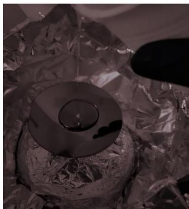
Figure 2.7 Etalement du PDMS sur le moule
