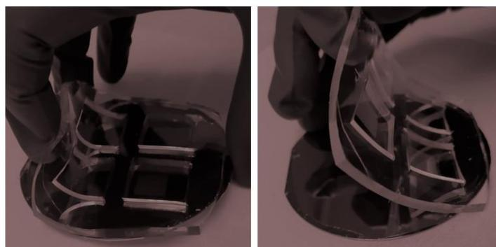
Figure 2.9 Démoulage de la membrane (En tirant délicatement le cadre se décolle du moule)
