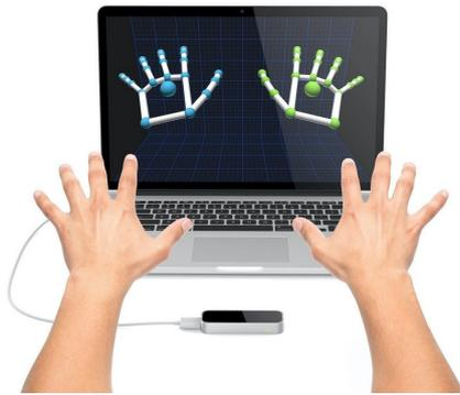
(a) Capture de mouvements avec la caméra stéréoscopique Leap Motion
