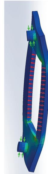
(b) Simulation par éléments finis de la déformation du support moteur. Flèches vertes : fixation au bâti; flèches rouges : sollicitation du servomoteur sur le support.
