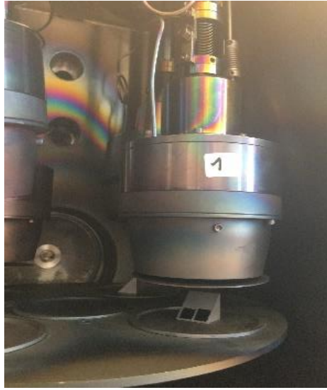
Figure 3.6 Support biseauté à 45^\circ placé sous une cible.
