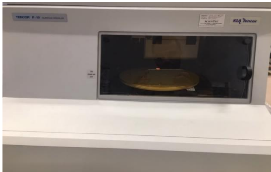
Figure 2.3 a) Profilométrie KLA TENCOR 10 b) Tracé du profil d'une couche FeCoB qui permet de déterminer la hauteur de la marche.
