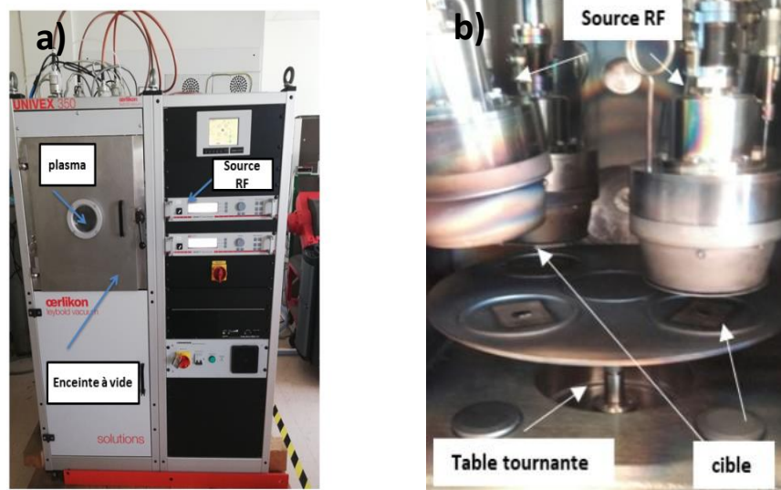
Figure 2.2 a) Bâti de pulvérisation cathodique et b) Chambre de l'enceinte interne.
