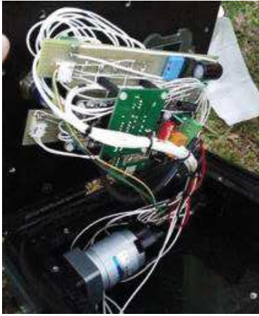
Fig. 7. Organisation interne du prototype de pompe péristaltique abandonné suite à une trop importante surchauffe interne du mécanisme. Crédit : V. Marques.
