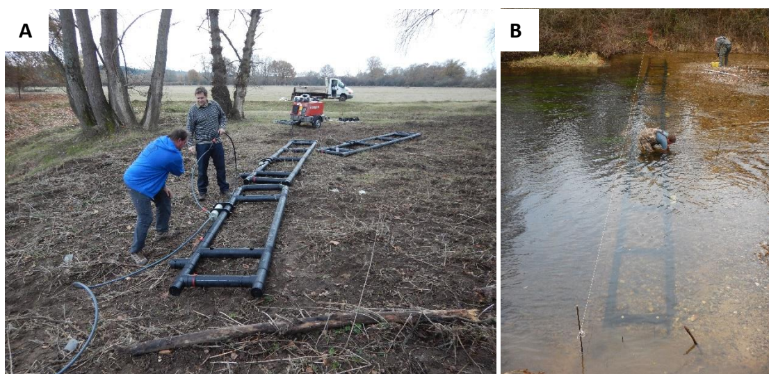
Figure 106 : Antenne RFID passif fixe utilisée dans le Cher (photos : T. Dépret, 29/11/2018)
