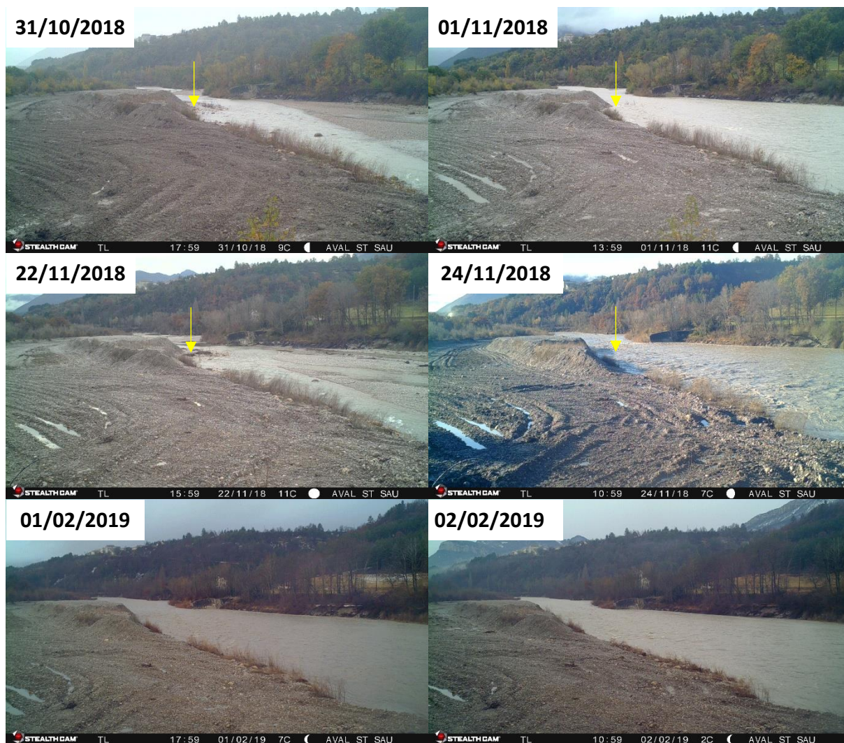
Figure 139 : Utilisation du suivi photographique pour caractériser l'évolution du remblai le long du Buëch
