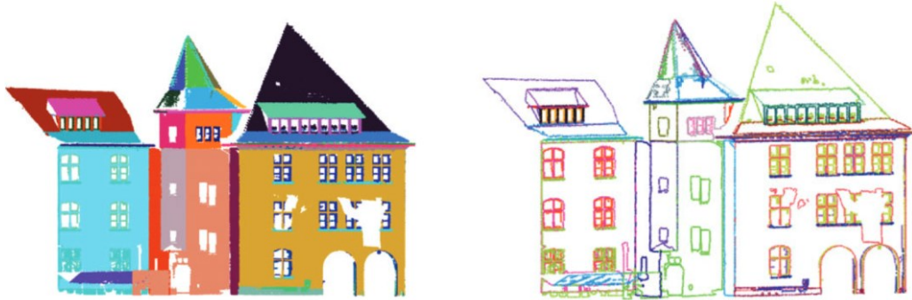
Figure 17 : Segmentation de façades en plans principaux (à gauche) et détection des points de contours (à droite), (Boulaassal et al., 2009)
