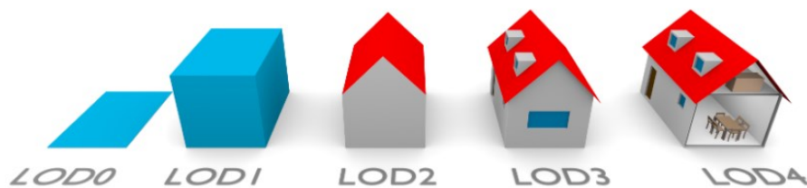
Figure 58 : Les cinq LODs de CityGML 2.0. Le détail géométrique et la complexité sémantique augmentent avec chaque niveau (Biljecki, F., 2017)
