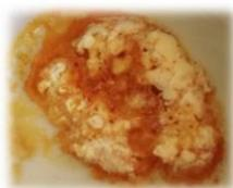
**Figure 99 - Photo de PL-4 en sortie d'étuve après 24h à 100°C**
