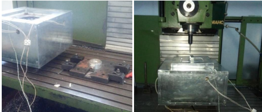
Figure II-11. Montage du Dispositif (WSPIF) sur le centre d'usinage CNC
