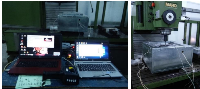
Figure II-13. Montage et essai mené par le dispositif de formage incrémental à chaud
