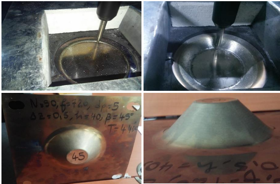
Figure II-32. Pièces réalisées à une température de 450°C
