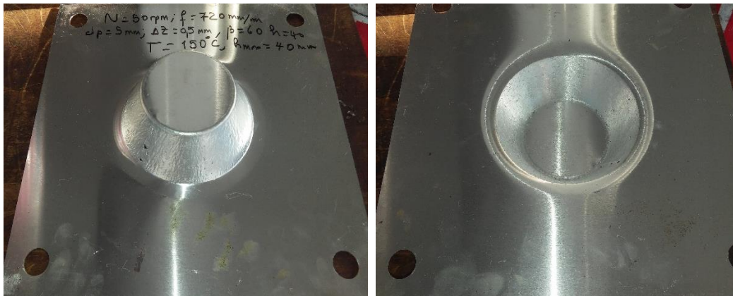
( d_p=5\text{mm} , D=130\text{mm} , \alpha=60^\circ , h=40\text{mm} , \Delta z=0,5\text{mm} et T=150^\circ\text{C} )
