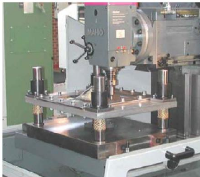
Figure I-11. Montage de SPIF sur une MOCN[18]
