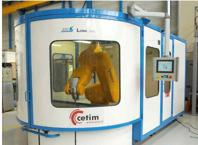
Figure I-14. Robot à structure en série d'usinage CETIM S4
