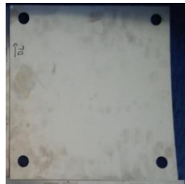
Figure II-17. Tôle de l'alliage de titane Ti-6Al-4V 2(e=0.5mm)
