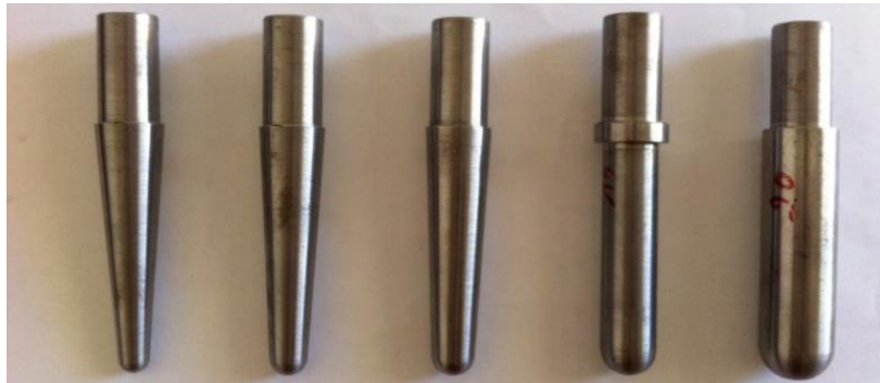
Figure II-15. Les poinçons utilisés, de diamètres ( d_p = 5, 8, 10, 15 et 20 )
