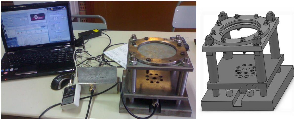
Figure I-6. Dispositif et chaîne d'acquisition des efforts de formage incrémental [18]
