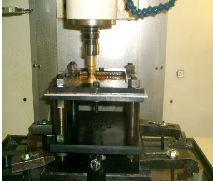
Figure I-11. Montage de SPIF sur une MOCN[18]
