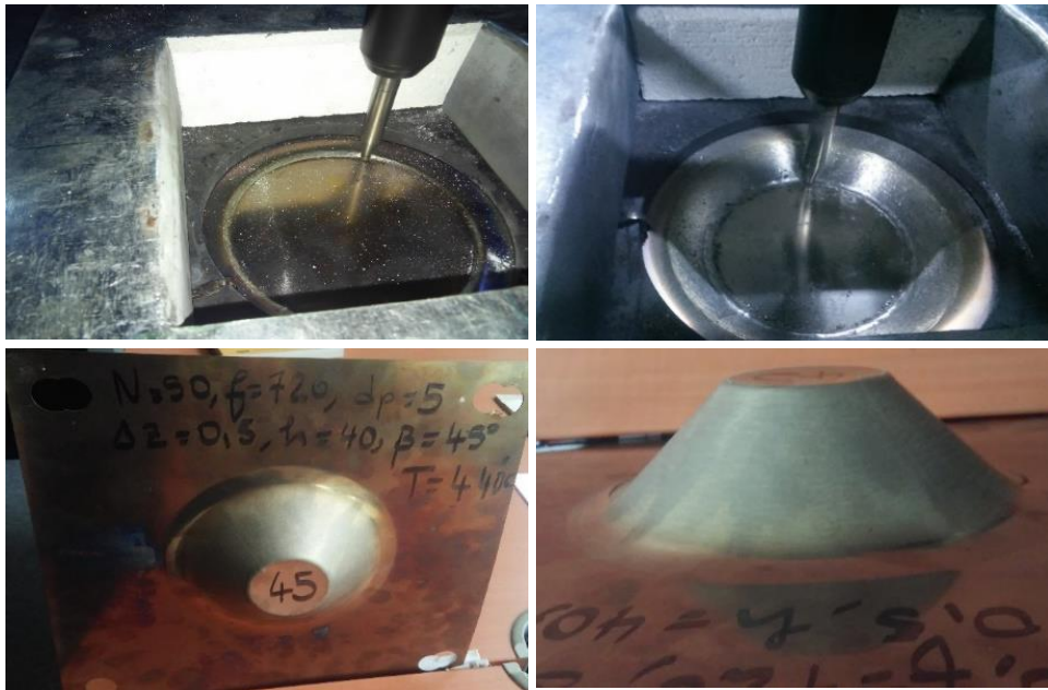
Figure II-32. Pièces réalisées à une température de 450°C
