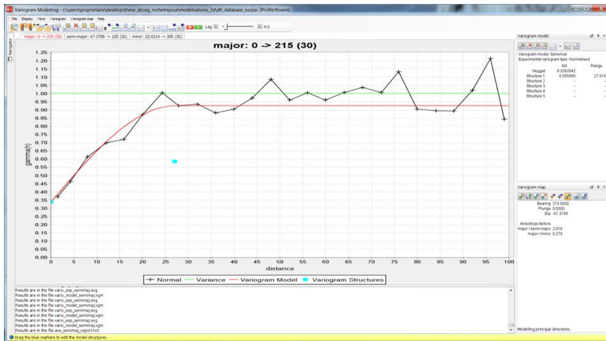
Figure 86 : Variogramme expérimental retenu pour le set de données suivant l'axe majeur de continuité géologique N35°E.
