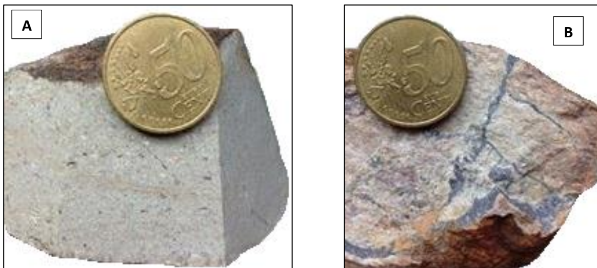
Figure 54 : A) Roche encaissante saine provenant de la formation de Bourgneuf, échantillon. B) Roche hydrothermalisée provenant des haldes du gisement des Brouzils, échantillon.
