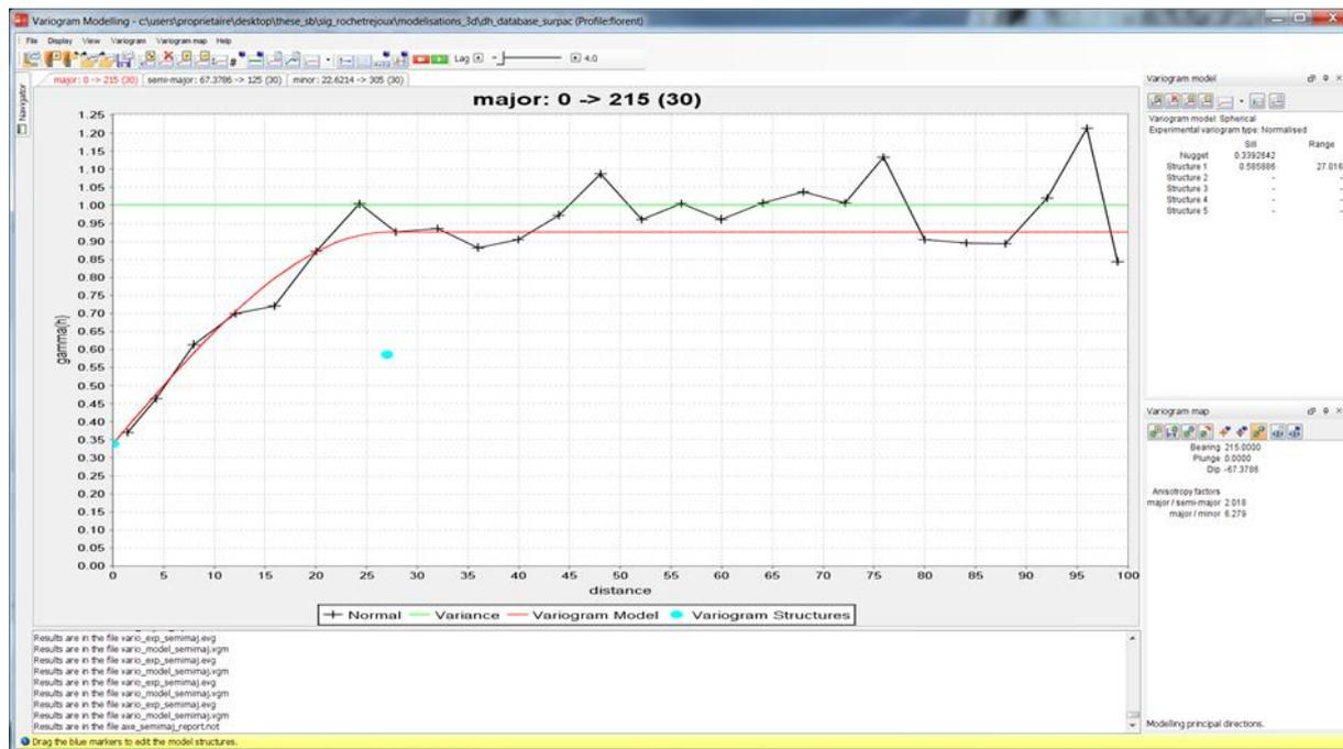
Figure 86 : Variogramme expérimental retenu pour le set de données suivant l'axe majeur de continuité géologique N35°E.
