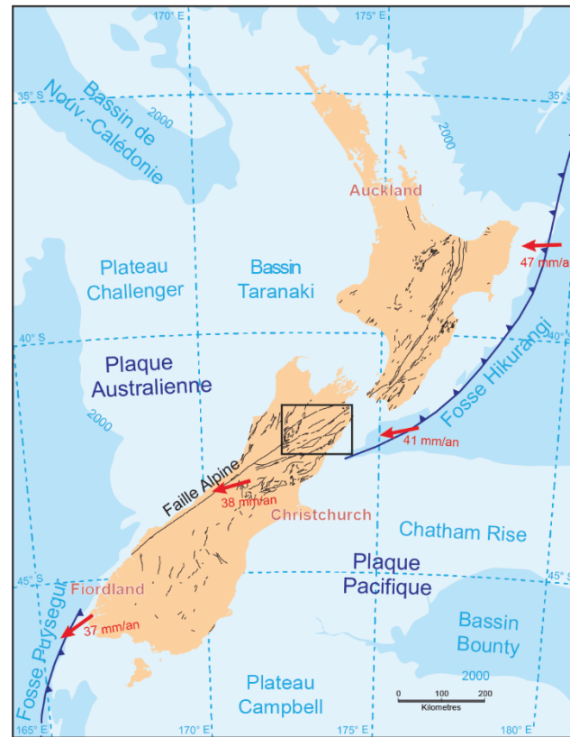
Figure 5.1. Contexte tectonique actuel de la Nouvelle-Zélande, et localisation géographique de la zone d'étude. La Nouvelle-Zélande se situe à la limite entre les plaques tectoniques australienne et pacifique, qui converge à un taux d'environ 41 \text{ mm an}^{-1} au niveau de la zone d'étude (encadré noir). La chaîne interne de Kaikoura se situe au nord de l'île de sud de la Nouvelle-Zélande. L'encadré noir délimite la zone d'étude, montrée à la Figure 5.2. (Figure traduite et modifiée de Rattenbury et al. (2006))
