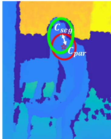
FIGURE 4.10 – Coefficient de distance. L'ellipse de la tête estimée par le suivi est en rouge et celle de la vérité terrain est en vert. La distance entre le centre de la tête estimé et la vérité terrain est le coefficient de distance.
