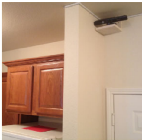
FIGURE 2.13 – Installation du dispositif de détection de la chute dans l'appartement d'une personne âgée [54].
