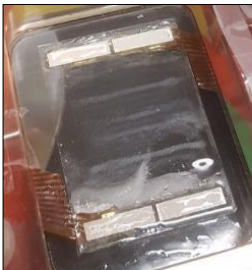
Figure 128: Images de lignes de culture cellulaire obtenues par la génération d'ondes de Lamb se propageant dans le substrat d'adhésion des cellules. Les zones blanches sur la plaque de verre correspondent aux lignes de cellules (expérience 3).
