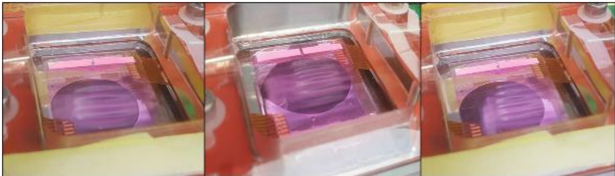
Figure 122: Images des déformations de la surface supérieure du liquide par la génération des ondes de Lamb 10 nœuds, 12 nœuds et 14 nœuds.
