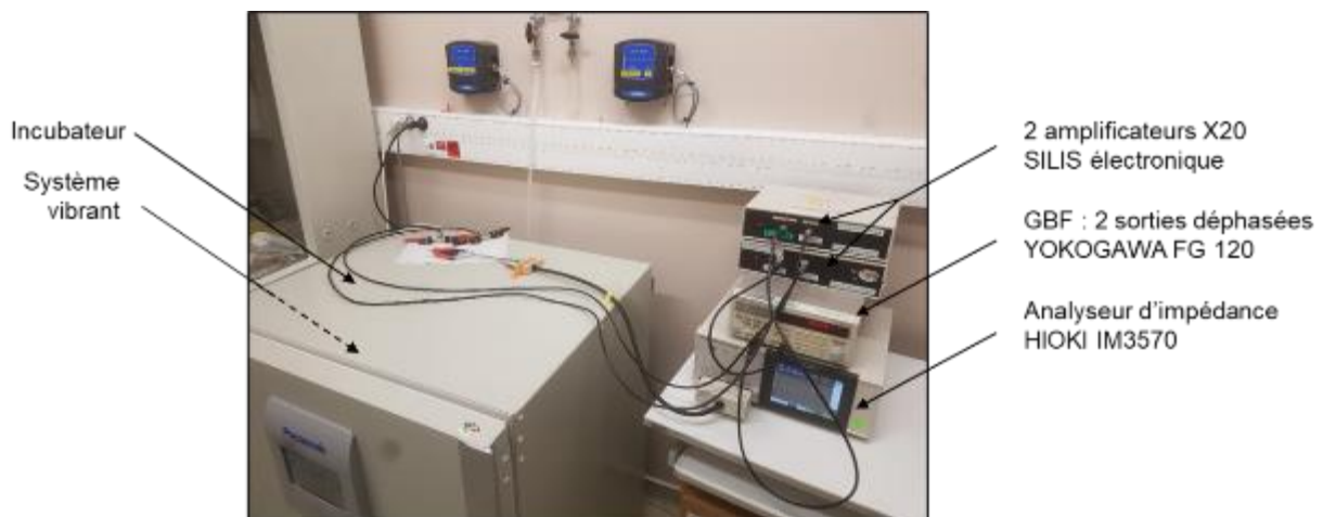
Figure 120: Image du montage expérimental utilisée pour la réalisation de patterning de culture cellulaire.
