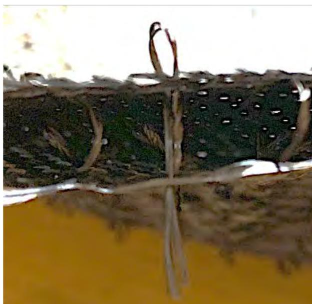
**FIGURE 4.4** – Boucle de piquage dans une préforme piquée
