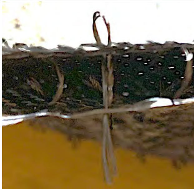
FIGURE 4.4 – Boucle de piquage dans une préforme piquée
