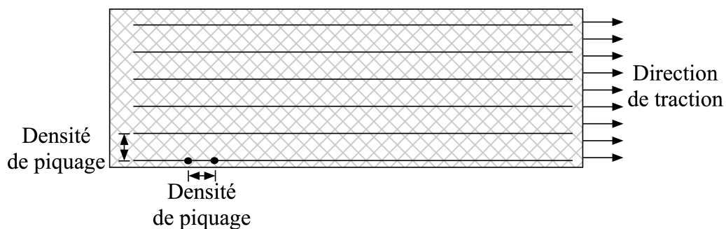
FIGURE 5.20 – Schématisation du Bias extension test avec le piquage de densité de 10 mm
