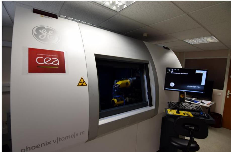
Figure III-6 : Photo de l'appareil de micro-tomographie aux rayons X au CEA/DES/ISAS/DPC/SECR/LECBA.
