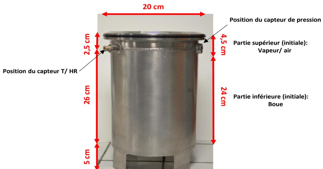
Figure V-2 : Cuve instrumentée dédiée au séchage de la boue B.
