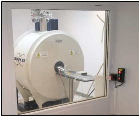
Figure 35 : A. Photographie de l'IRM utilisé (issu de cyceron.fr). B. Exemple d'images T2 acquises post-mortem sur un cerveau de souris conservé dans son crâne.
