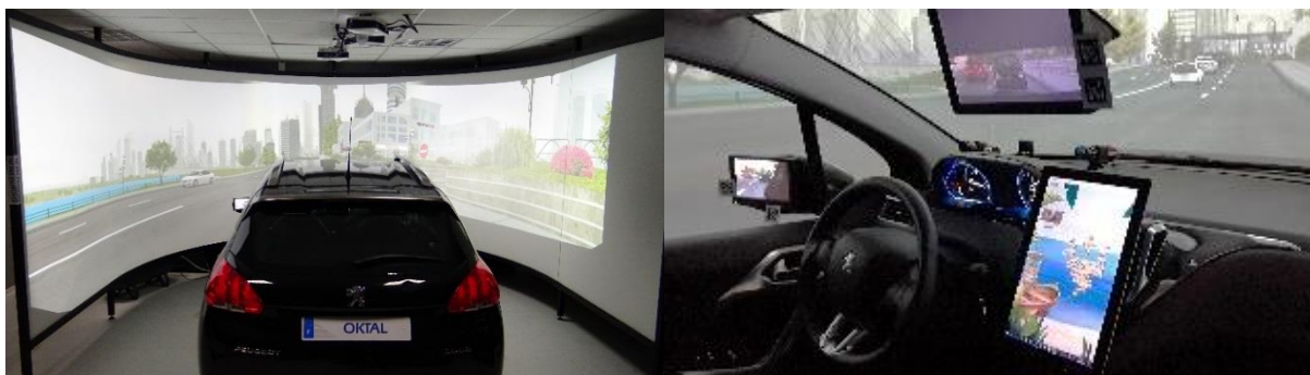
Figure 12 : Simulateur de conduite, vue intérieure et extérieure (Peugeot 2008)
