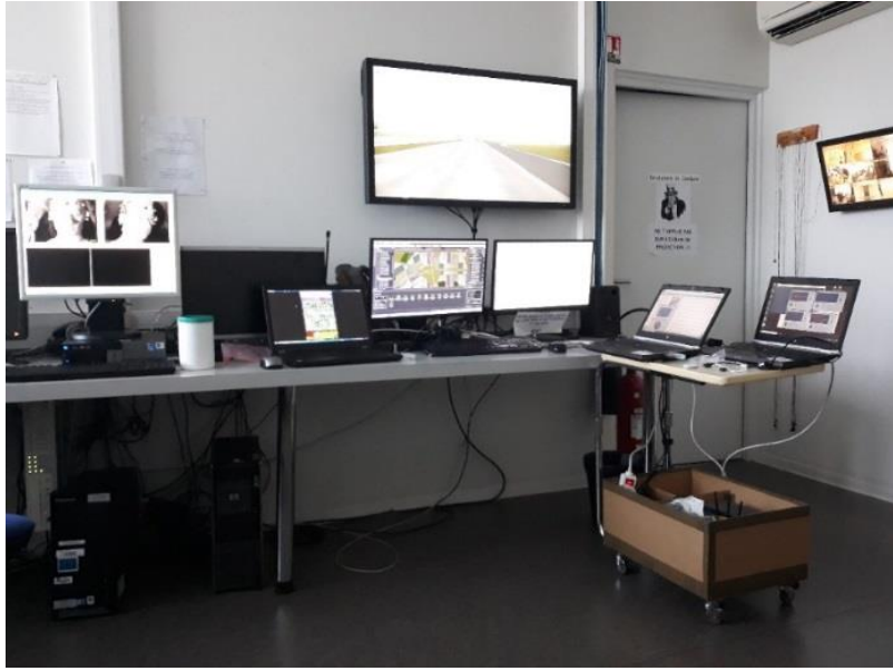
Figure 13 : Vue globale de la salle de contrôle du simulateur de conduite (matériel mis en place pour l'enregistrements des paramètres physiologiques et comportementaux et celui des performances de conduite).
