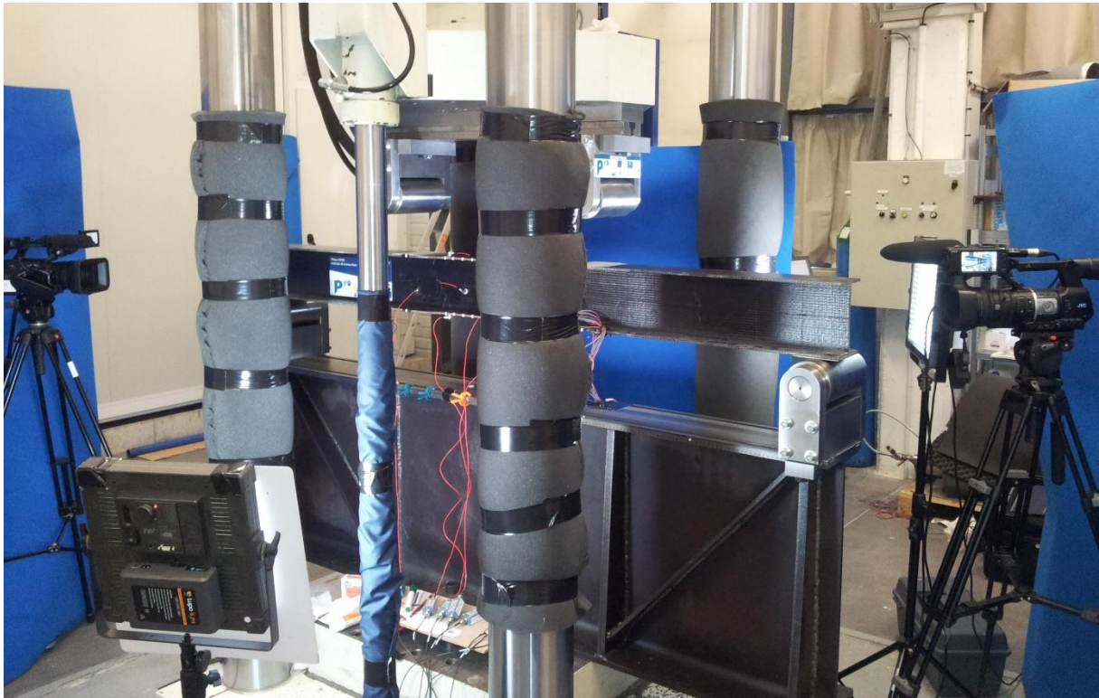
Figure IV-52 : Photo du montage d'essai de flexion 4 points avec l'éprouvette et la métrologie en place
