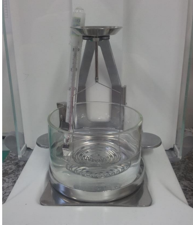
Figure III-3 : Dispositif de pesée d'un échantillon dans l'air et dans un fluide
