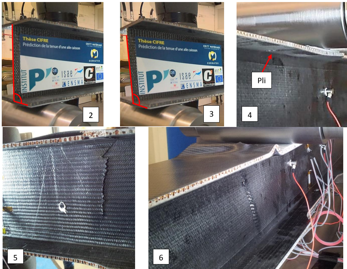
Figure IV-55 : Photos de l'écrasement sous les appuis (1), du déversement (2,3), de plissement des semelles (4) et de la rupture des éprouvettes (5,6)
