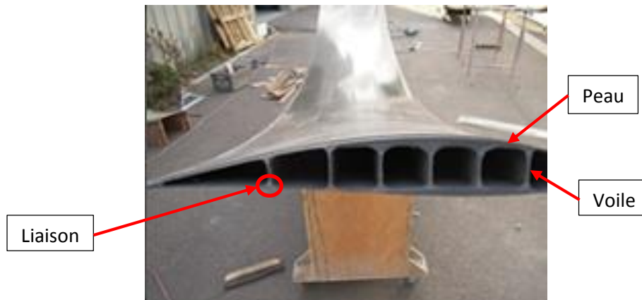
Figure I-3 : Photo d'un foil avec une construction en caisson creux
