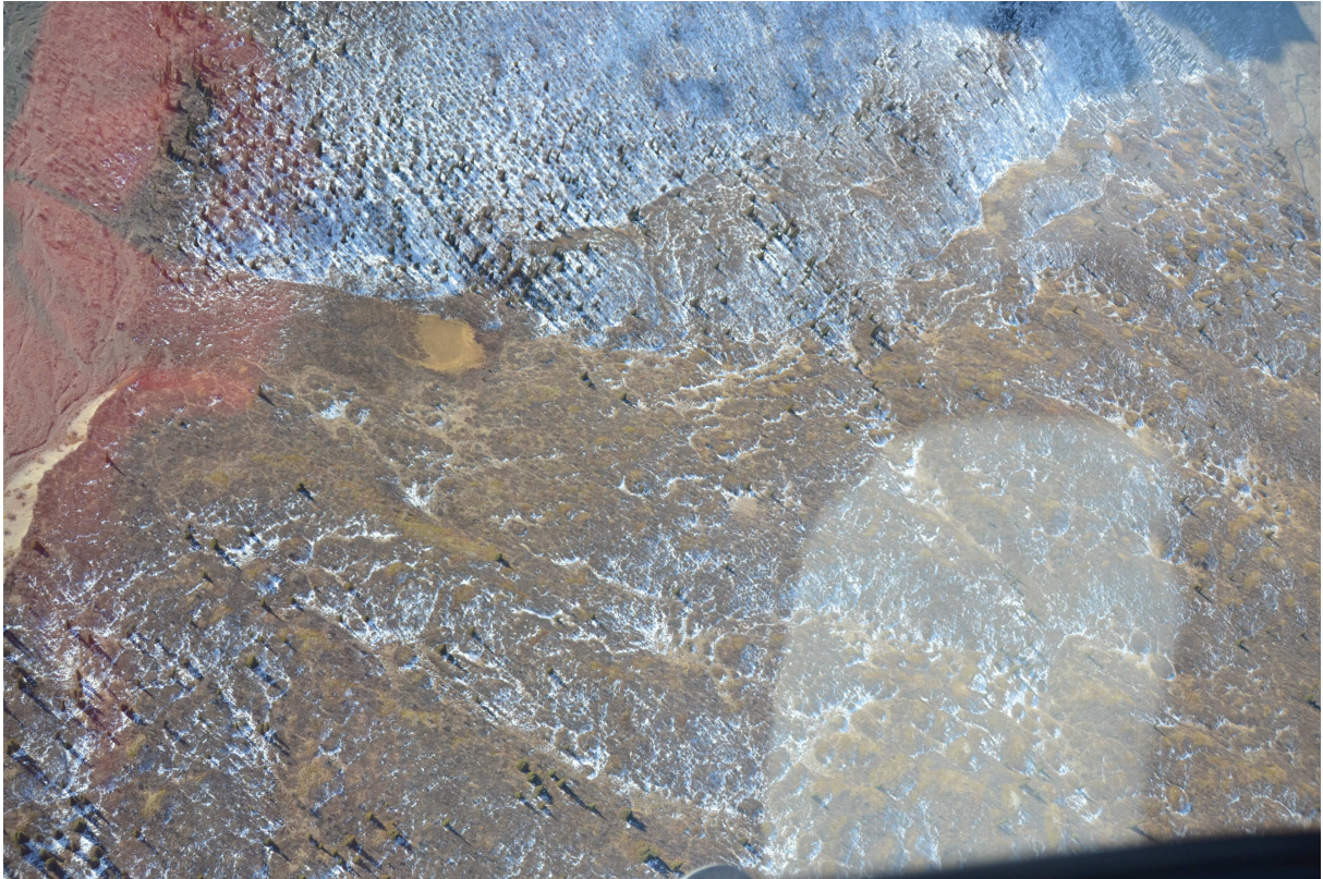
Figure 88 : Exemple d'une photo problématique lors du traitement des images : des reflets (rouge et gris/bleu) perturbent la corrélation, et la fenêtre et le patin en bas sont à masquer.
