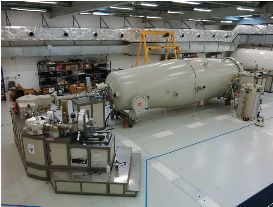
Figure 131 : Spectromètre de masse ASTER (Cerege). Sur cette photo, on voit la colonne d'injection (à gauche) et l'accélérateur (au centre). La colonne d'analyse est absente de la photographie.
