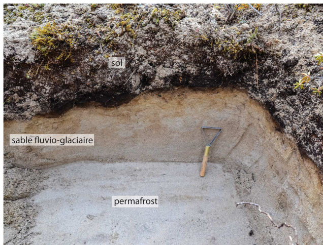
Figure 124 : Exemple d'une tranchée d'échantillonnage au site DEN2. Sous une couche de sol de ~ 30 cm, on trouve une couche de sable de ~ 30 cm avant d'atteindre le permafrost.
