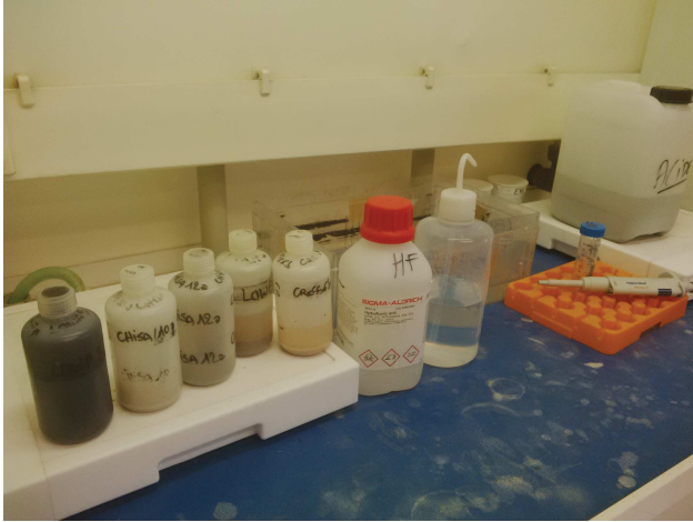
Figure 130 : Photographie d'illustration de l'étape de dissolution des minéraux (autres que le quartz) au HF.
