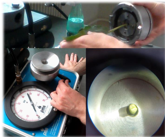
Photo : Mise en place d'une feuille dans la chambre à pression de Scholander et surveillance de l'apparition du ménisque de sève au sommet de la section du pétiole.
