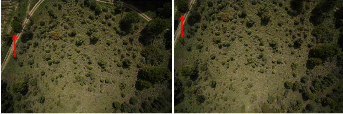
FIGURE 5.2 – Effet de vignettage. Les coins de l’image sont plus sombres que son centre. L’effet est également notable en observant l’arbre indiqué par une flèche qui se retrouve assombri dans l’image de droite lorsqu’il apparaît dans le coin de l’image.
