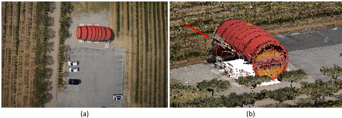
FIGURE 5.18 – Erreurs de colorisation des structures verticales illustrées sur le domaine de Puech-Haut; (a) image utilisée pour coloriser la zone indiquée par la flèche rouge dans (b). Des faibles erreurs de mesure ou de positionnement de l'image peuvent créer des erreurs de colorisation visibles à cause de la stratégie de colorisation employée.
