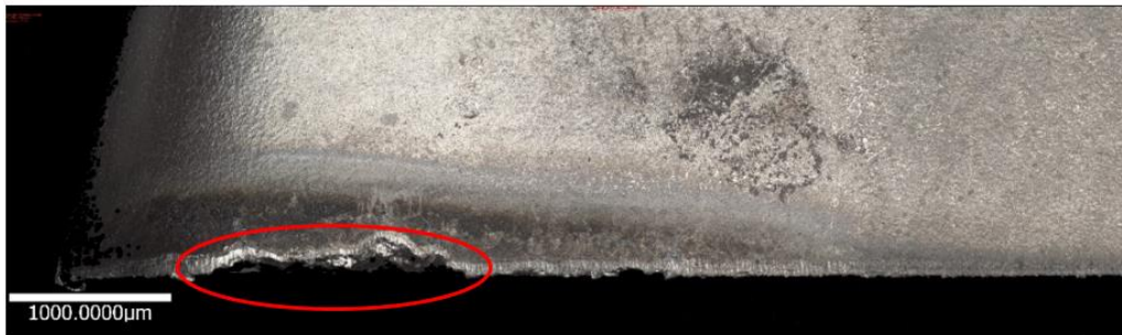
Figure II.31 : face de dépouille en fin de vie de la plaque JL après 22 min d'usinage ( V_c = 60 \text{ m/min} ; f_z = 0.2 \text{ mm/dent} ; a_e = 4 \text{ mm} )
