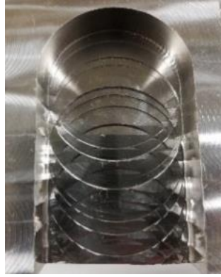
Figure III.11 : Surface générée par l’outil AQX ( kr < 90^\circ ) en fond de poche
