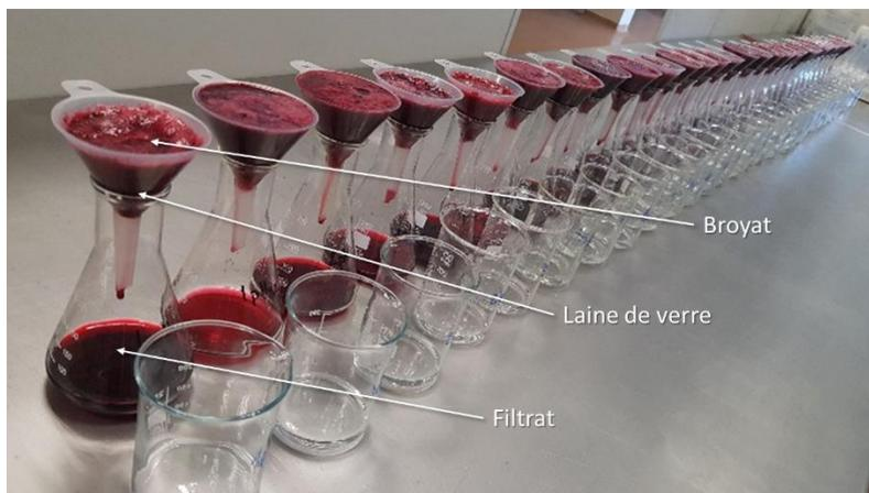
Figure 35 : Etape de filtration de la méthode Glories, obtention des filtrats qui permettront l'analyse de la composition phénolique
