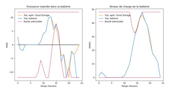
FIGURE 4.8 – Planification des trajectoires de la batterie à l'intérieur des bandes admissibles avec un faible impact sur le service de Cloud Storage
