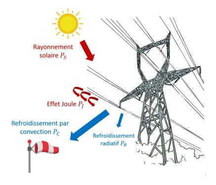
FIGURE 3.2 – Facteurs affectant la température d'un conducteur
