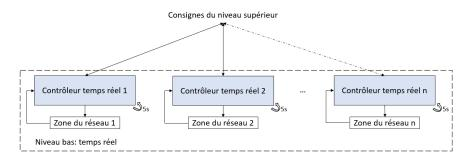
FIGURE 2.1 – Niveau bas du système de pilotage
