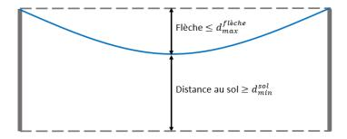
FIGURE 3.1 – Description de la flèche d'une ligne électrique
