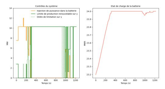
FIGURE 2.10 – Actions prises par le contrôleur : cas de mise en évidence du caractère non robuste du contrôle
