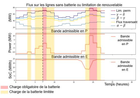
FIGURE 4.4 – Un exemple du calcul de bandes admissibles avec des congestions en N
