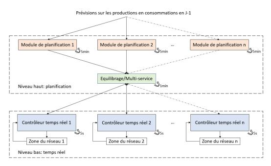
FIGURE 1.8 – Architecture du système de pilotage des batteries
