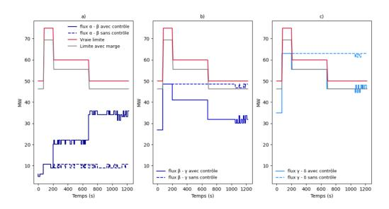
FIGURE 2.7 – Comportement des flux de la zone : cas avec incident
