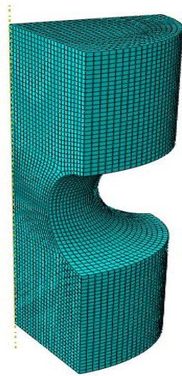
(a) ¼ de l'éprouvette ronde entaillée
