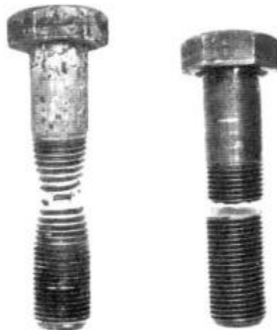
Figure 2- 1: La différence entre la rupture ductile à gauche et rupture fragile à droite [Tayl07]
