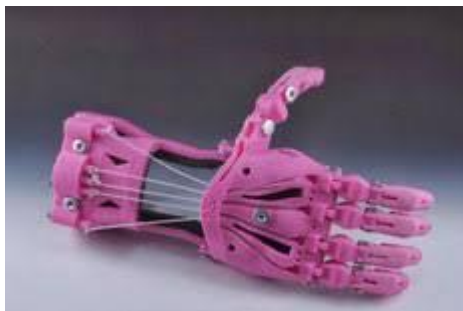
Figure 9 : Main articulée produite par impression 3D 32
