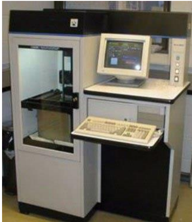
Image 1 : Imprimante SLA 250, première imprimante 3D commercialisée en 1988 7
