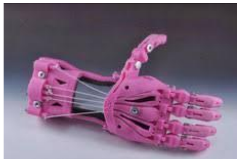
Figure 9 : Main articulée produite par impression 3D 32
