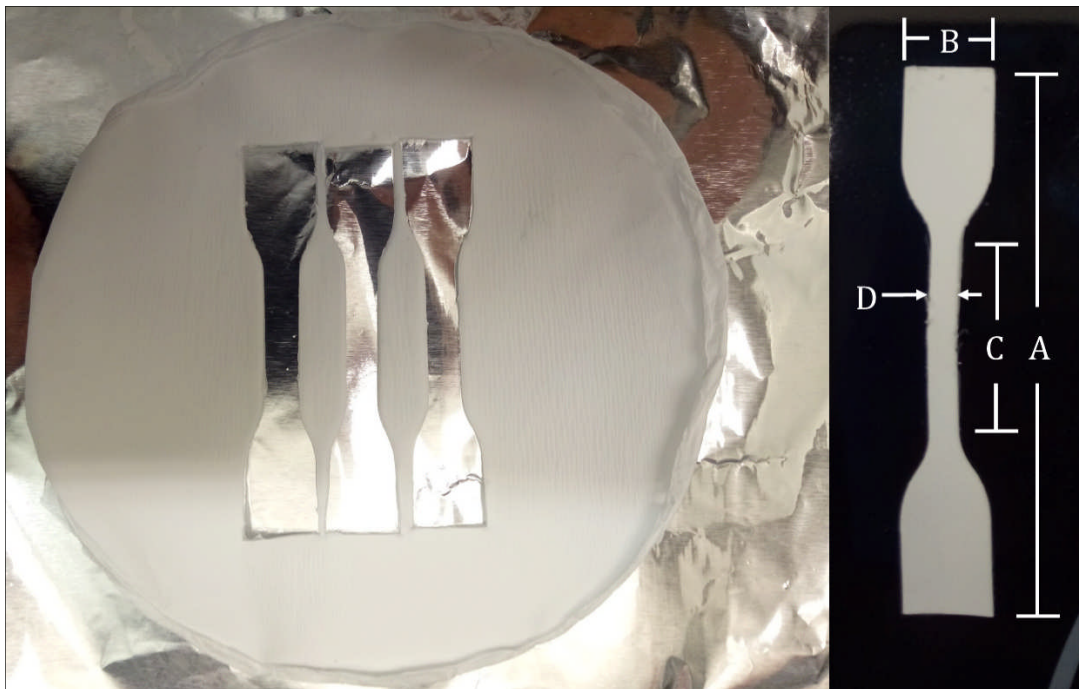
Figure 55 : (gauche) Découpe des éprouvettes sur une membrane en fibres PCL électrofilées et (droite) éprouvettes type H3.
