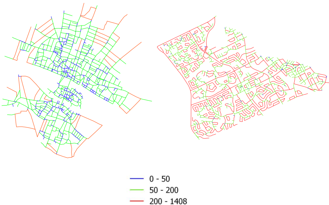
Figure 6.8 : Cartes de la longueur des tronçons, discrétisée en trois classes, pour le réseau de Paris (gauche) et celui de la banlieue de Waterloo (droite). A Paris, les tronçons de plus de 200 mètres (en rouge) sont peu nombreux, alors qu'ils sont majoritaires dans la banlieue de Waterloo.
