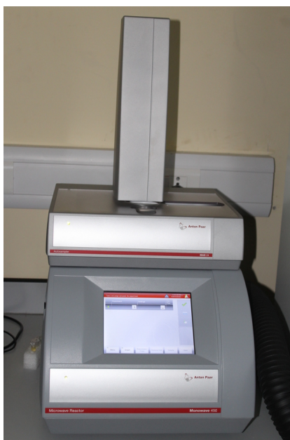
FIGURE II.8: Réacteur micro-ondes utilisé pour le prétraitement Organosolv (Monowave 450, Anton Paar, Autriche)
