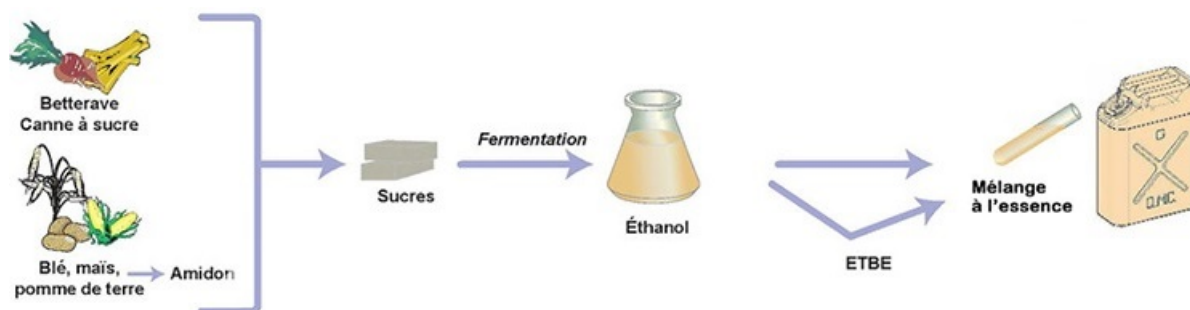
FIGURE I.5: Description synthétique de la voie de production de bioéthanol de première génération.
