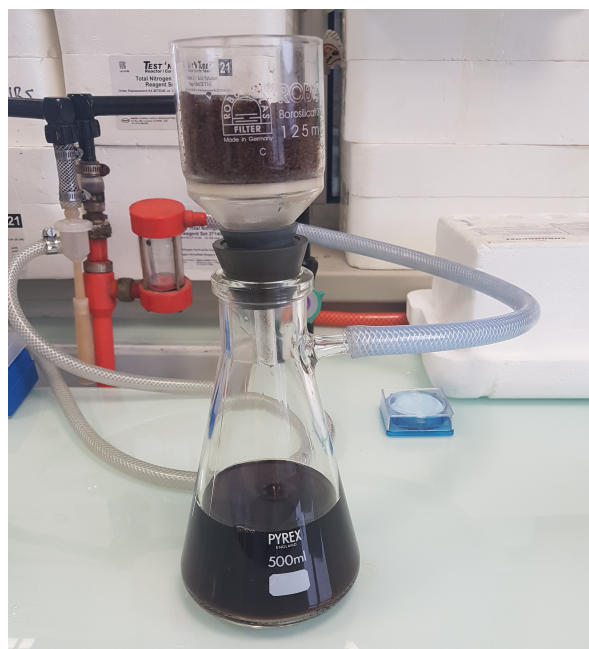
FIGURE II.10: Étape de séparation solide/liquide (pâte/liqueur noire)
