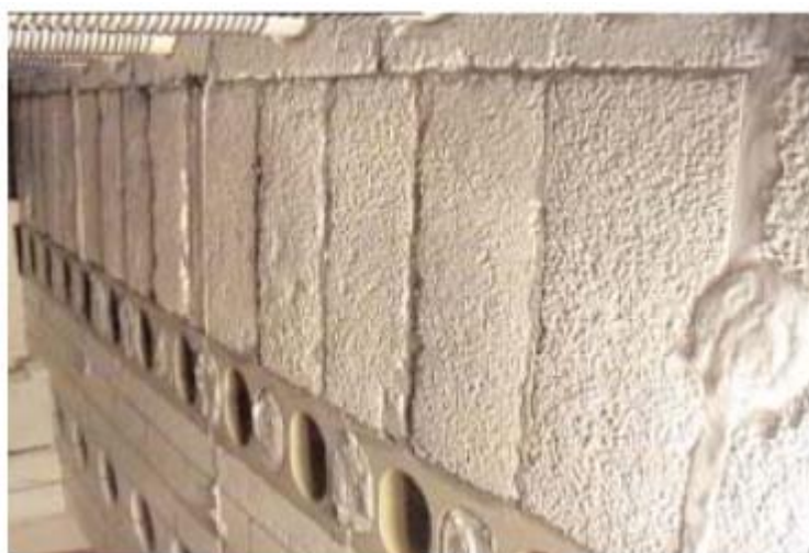
Figure I.4-10 Surface d'un four à rouleaux couvert avec des formes préfabriquées
