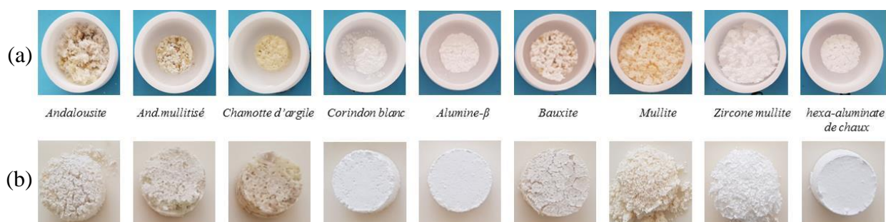
Figure IV.5-2 Photographies des pastilles après essai de corrosion à 1200°C a) Grains de granulométrie 0.5-1.6mm b) Grains de granulométrie < 63 µm
