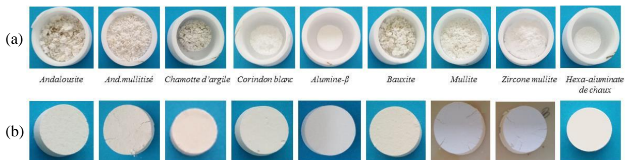
Figure IV.4-2 Photographies des pastilles après essai de corrosion à 1200°C a) Grains de granulométrie 0.5-1.6mm b) Grains de granulométrie < 63 µm
