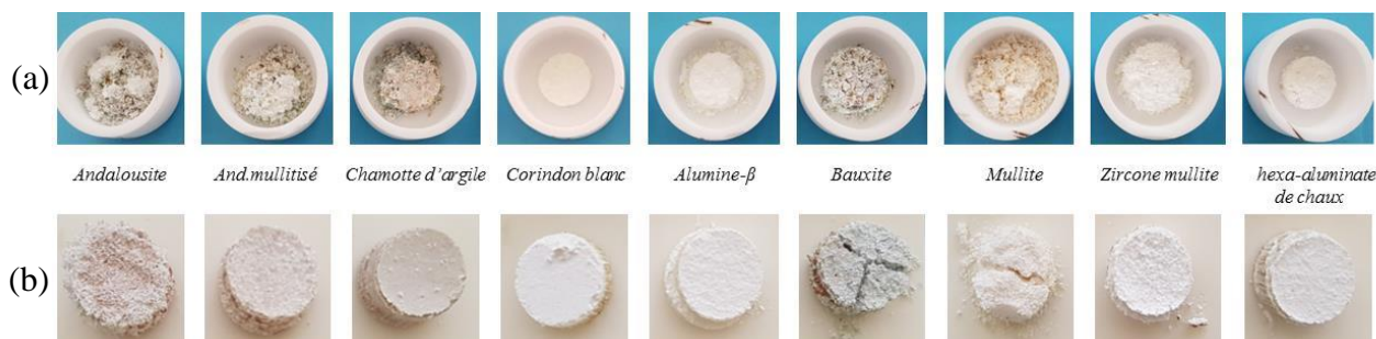
Figure IV.5-1 Photographies des pastilles après essai de corrosion à 800°C a) Grains de granulométrie 0.5-1.6mm b) Grains de granulométrie < 63 µm
