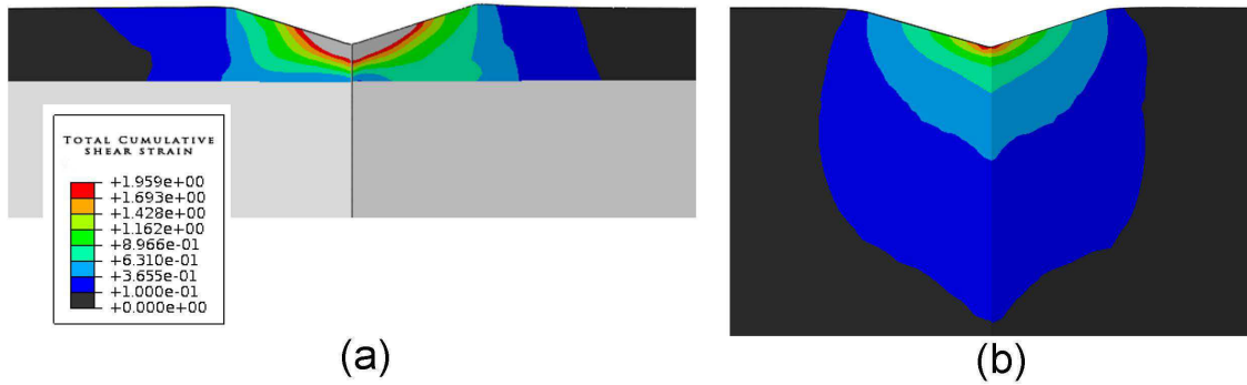
Figure 82 Coupe représentant le champ de glissement cumulé du (a) film/substrat et (b) du massif à 1500nm de pénétration (50% de l'épaisseur du film) correspondant à la Figure 81.
