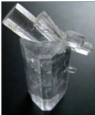
Le **sel de Rochelle** (du tartrate de potassium et de sodium  $\text{NaKC}_4\text{H}_4\text{O}_6$ ) est un ferroélectrique ayant un effet piézoélectrique important utilisé dans des dispositifs acoustiques et de vibration sensibles. Il est ferroélectrique dans un domaine de température compris entre  $-18$  et  $24^\circ\text{C}$  pour lequel le cristal est monoclinique. En dehors de cette plage de température, le cristal est paraélectrique avec un groupe spatial orthorhombique [8-10].
