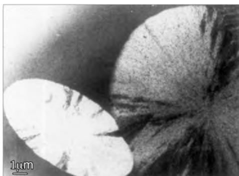
FIGURE 1.5 – Image MET d'une cristallisation de verre métallique  $\text{AlFeSi}$  issue d'un chauffage "in-situ" d'une lame mince jusqu'à  $800^\circ\text{C}$  en MET (d'après la réf. [74]). Due à la fine épaisseur de l'échantillon de lame mince, les grains cristallisés correspondent à des tranches d'ellipsoïdes. Chaque tranche contient le centre d'ellipsoïde correspondant au germe de cristallisation.
