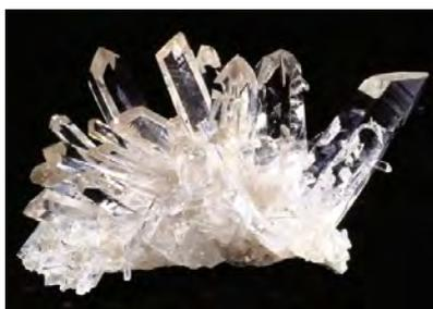
Le **Quartz** de composition chimique correspondant à de la silice pratiquement pure (100%  $\text{SiO}_2$ ). La structure cristalline du quartz intègre toutefois une certaine quantité d'oligoéléments. Al, Fe, Ga, Ge, Ti, et P en substitution sur des sites Si [11]. Le Quartz présente une fort effet piézoélectrique perpendiculairement à l'axe du prisme [12, 13].
