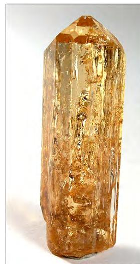
La **Topaze** est une espèce minérale du groupe des silicates de formule  $\text{Al}_2\text{SiO}_4(\text{F},\text{OH})_2$ . Sa structure cristalline est constituée de monocouches d'anions d'oxygène en alternance avec des monocouches de Al et Si. Un tiers des sites octaédriques disponibles sont remplis avec des Al et un douzième des sites tétraédriques avec Si. Les atomes d'oxygène sont coordonnés par une liaison Si et deux atomes Al, et le fluor par des atomes Al [15].
