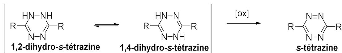
**Schéma 30.** Synthèse d'une tétrazine par oxydation d'une dihydrotétrazine
