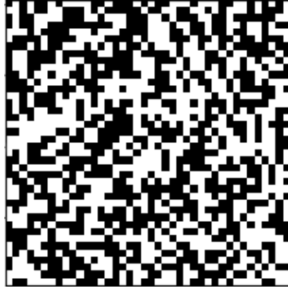
FIGURE 0.1.1. Un environnement typique satisfaisant les hypothèses de stationnarité et de dépendance à portée finie est le damier : on choisit deux matrices (déterministes) symétriques définies positives \mathbf{a}_1 et \mathbf{a}_2 . L'environnement \mathbf{a} est défini de telle sorte que \mathbf{a} est égal à \mathbf{a}_1 sur les cellules noires et égal à \mathbf{a}_2 sur les cellules blanches. La couleur des cellules est choisie grâce à une percolation de Bernoulli par site de probabilité p \in [0, 1] .
