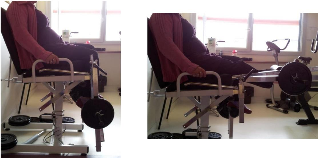
Figure 44: position de départ et d'arrivée des tests dynamiques d'extension de quadriceps (mesure de 1RM et TlimQ). NB: sur ces images, les bras du sujet ne sont pas en position correcte, lors des tests ils sont croisés sur la poitrine.
