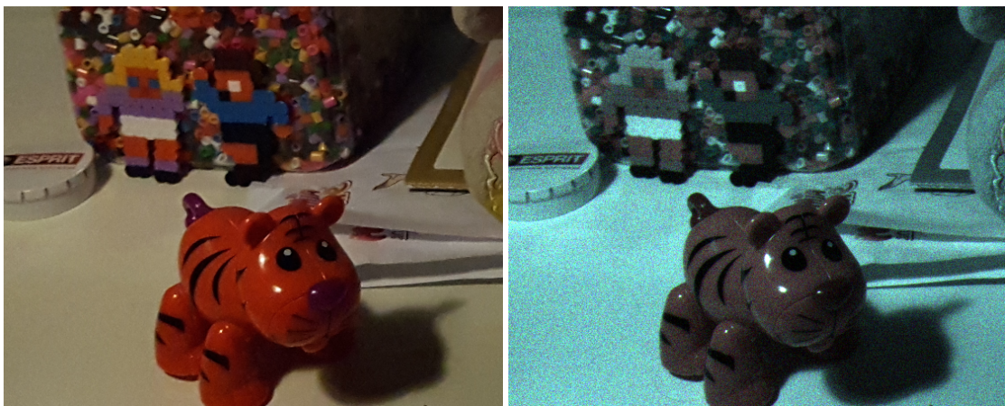
Figure 12: Bien que l'image produite par un téléphone Samsung Galaxy S7 ne semble pas être bruitée (gauche), l'image brute correspondante telle que vue par le capteur est en fait très bruitée (droite). L'image finale est produite par une chaîne complexe de traitement d'image qui applique un débruitage lors d'une des différentes étapes.
