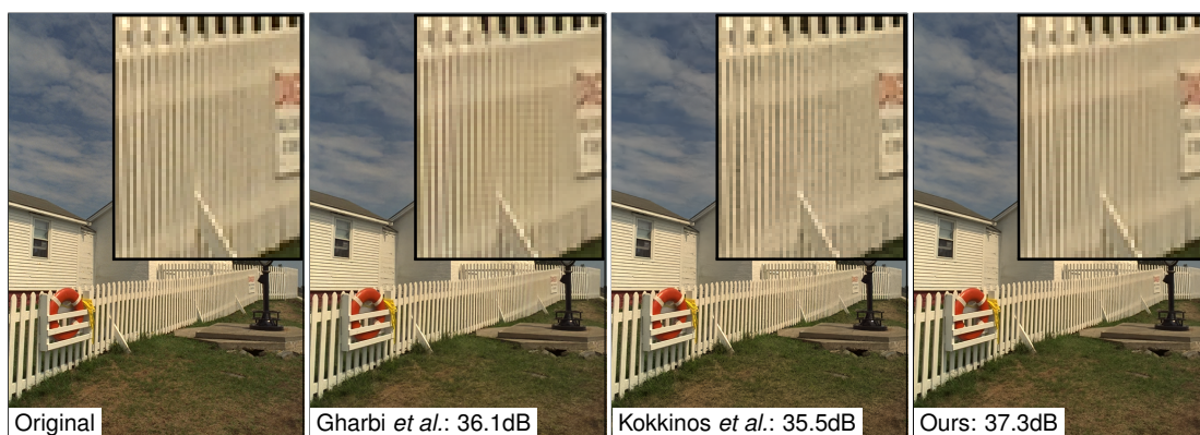
Figure 19: En utilisant une acquisition rafale, notre méthode de raffinement de réseau de neurones (en utilisant comme point de départ le réseau de Gharbi et al. [GCPD16]) est capable non seulement de débruiter correctement ( \sigma = 5 ) mais aussi de ne pas produire d'artefacts visuels comme le zipper ou moiré dans les régions difficiles.
