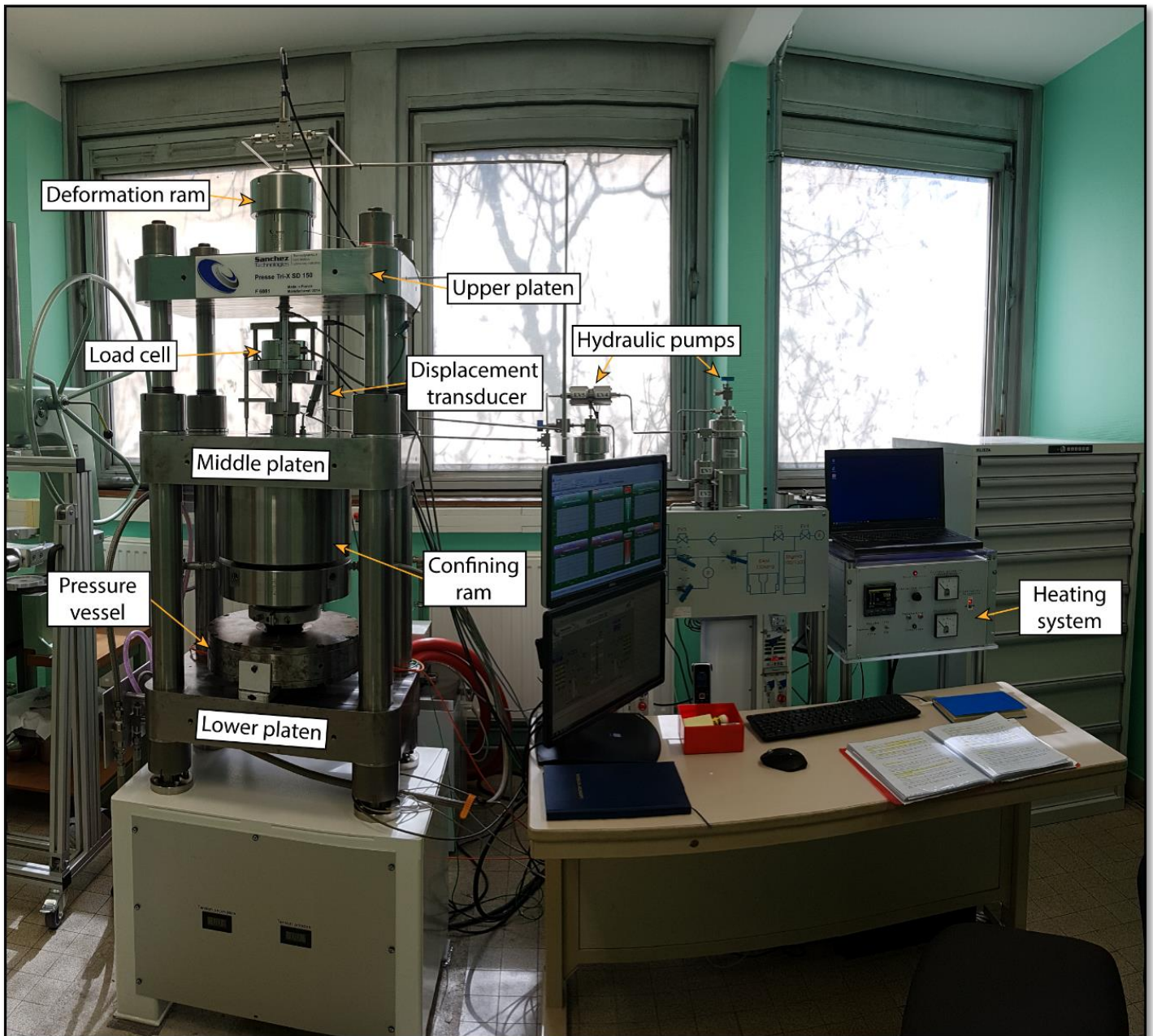
Fig 1: Overview of the deformation apparatus available at the Institut des Sciences de la Terre d'Orléans (ISTO, France).
