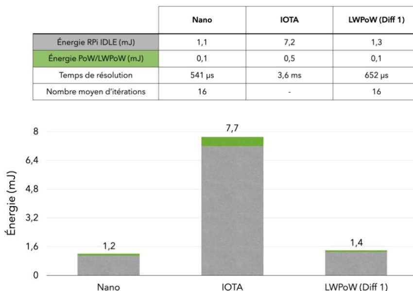
Figure 3-29 - Comparaison énergétique du LWPoW avec les PoW de Nano et IOTA à difficulté équivalente
