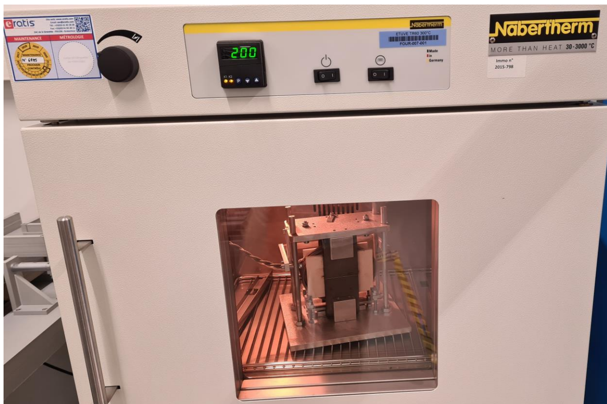
Figure II-10 : Cadre SST placé dans une étuve à 200 °C
