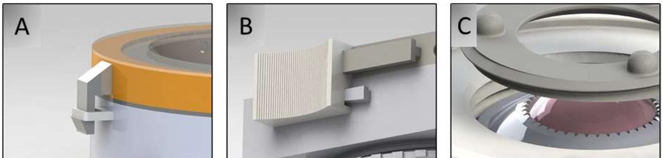
*Figure 21 : Reconstruction en 3D représentant l'évolution des systèmes de verrouillage du BR. (A) verrouillage par clip (BRv3) ; (B) verrouillage par rampes opposées (Brv6); (C) verrouillage par pas-de-vis (BRv9). (EA 2521 BiiGC, Université Jean Monnet, Saint Etienne, Bernard A.)*
