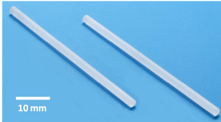
Figure V-22 : Photographie des barreaux laser ( $\varnothing = 1$  mm,  $l = 40$  mm), usinés à partir de la céramique ( $\varnothing = 50$  mm,  $e = 2$  mm) frittée par SPS à  $2^{\circ}\text{C}/\text{min}$ .
