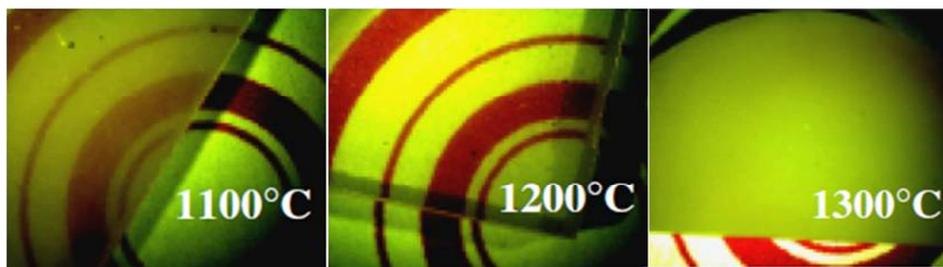
Figure I-32 : Evolution de la qualité optique de spinelles frittés par HP en fonction de la température d'application de la pression maximale [172].
