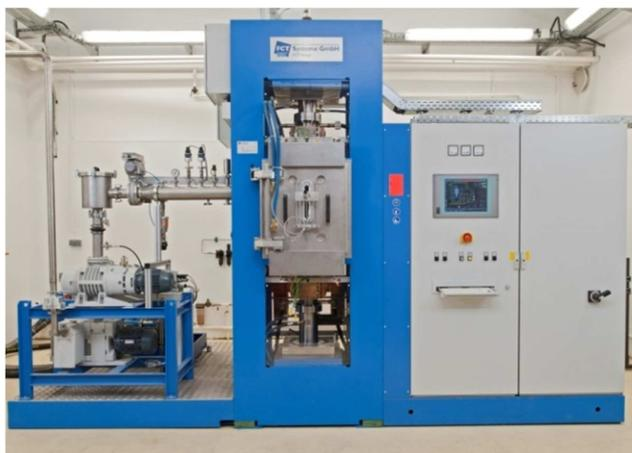
*Figure C-1 : Appareil SPS de type HP D 125 (FCT Système GmbH) utilisé à l'ISL.*
