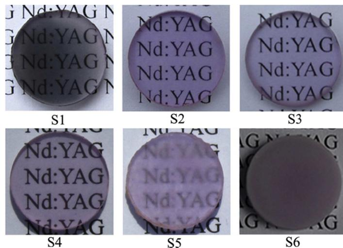
Figure I-29 : Photographies des céramiques Nd:YAG (S1) après frittage naturel à 1780°C, (S2) après recuit sous air à 1450°C, (S3) après recuit sous air à 1450°C + post-HIP à 1700°C, (S4) après recuit sous air à 1450°C + post-HIP à 1700°C + recuit sous air à 1250°C, (S5) recuit sous air à 1350°C et (S6) recuit sous air à 1450°C [89].
