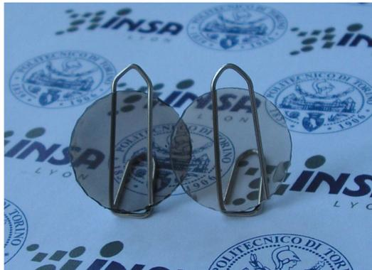
Figure I-28 : Photographies des céramiques YAG frittées par SPS à 1350°C, avant (à gauche) et après (à droite) recuit sous air à 900°C pendant 1h [151].
