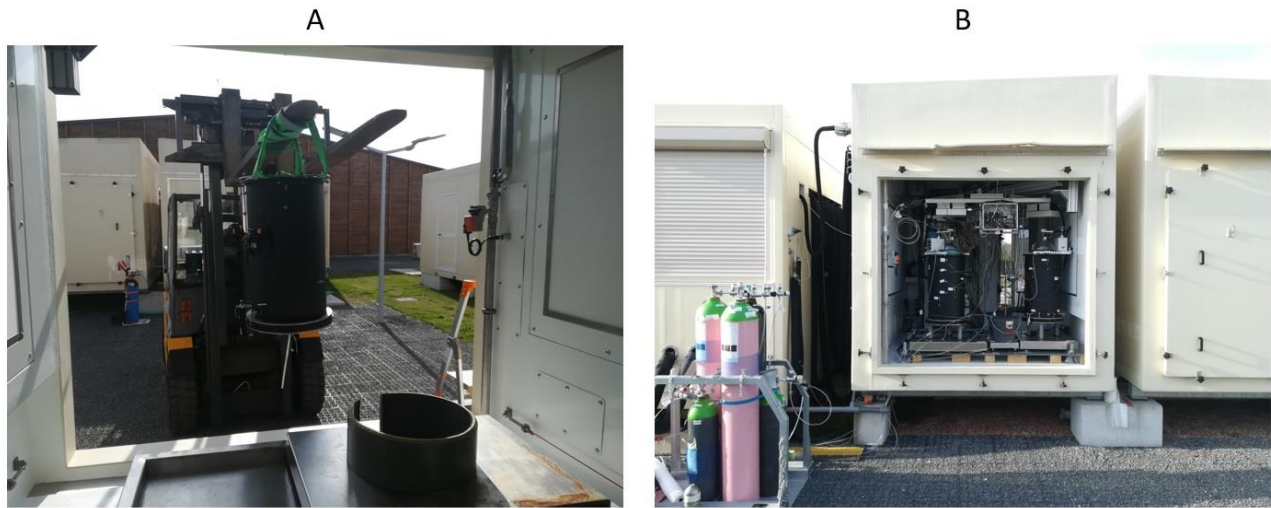
Figure II-18 : (A) Mise en place d'une colonne de sol dans la cellule climatique à l'aide d'un chariot élévateur. (B) Installation terminée des deux colonnes de sol dans la cellule climatique en présence des bouteilles de gaz utilisées pour les injections et les calibrations.
