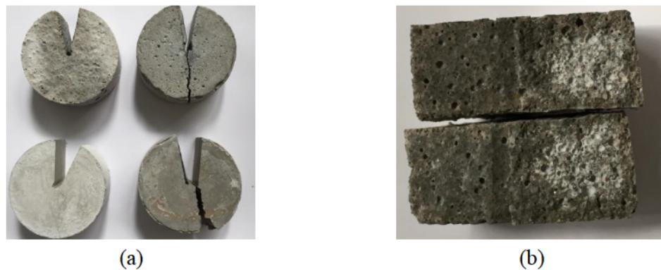
Figure 6.10: (a) Les échantillons avec entaille utilisés dans les essais de fendage par coin, avant et après fissuration. (b) Échantillon de mortier saturé durant l'essai, après rupture.
